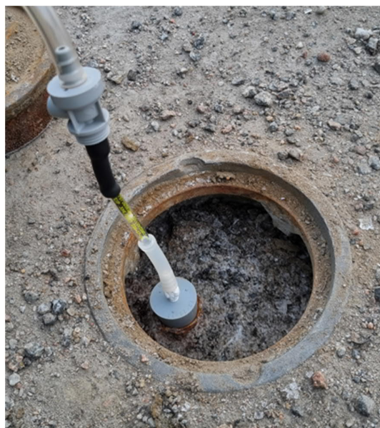
Figur 2. Aktivt pumpad provtagning av porgas i provpunkt 22W202PL.
