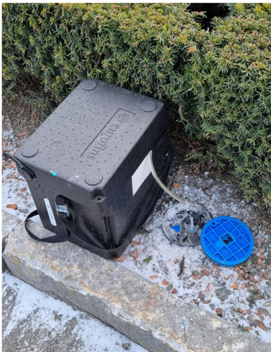
Figur 1. Aktivt pumpad provtagning av porgas i punkt 22W204PL.
